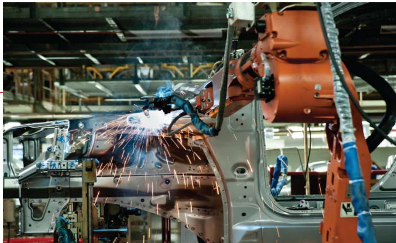
Pemasangan berautomasi di kilang kereta Proton.
